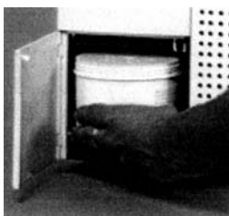
Kép 5-6 Az illatszselé tartály behelyezése
